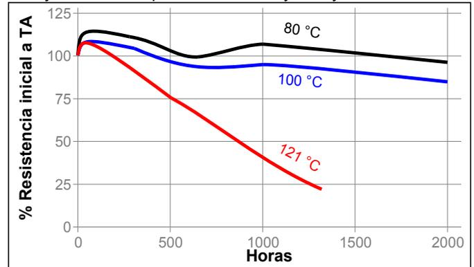
**Envejecimiento a Temperatura/Resistencia al Calor**
